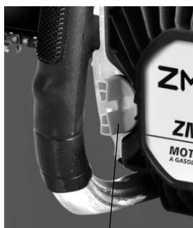
Reservatório de óleo
