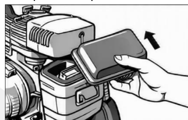
Fig. 15 – Limpeza do filtro de ar
