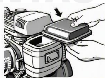
Fig. 17 – Limpeza do filtro de ar
