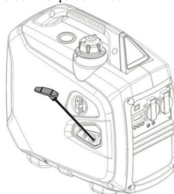
Fig. 7 – Partida do Gerador
