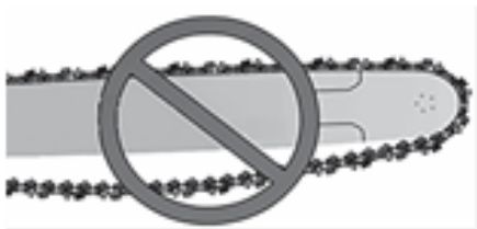
Fig. 11 – Tensionamento incorreto da corrente
