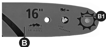
Fig. 18 – Lubrificação do rolamento da ponta do sabre
