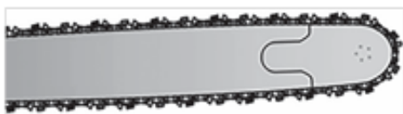
Fig. 12 – Tensionamento correto da corrente
