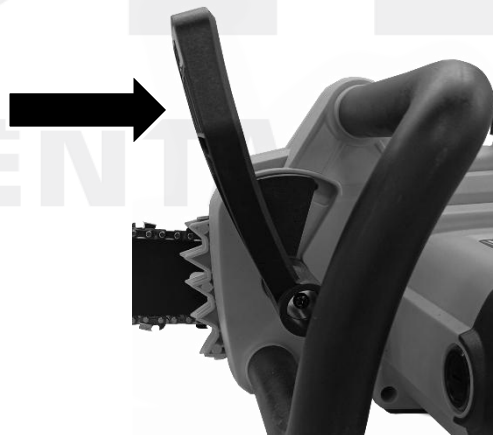
Fig. 22 – Liberando a trava da corrente
