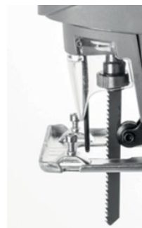
Fig. 3 – Instalação correta da lâmina
