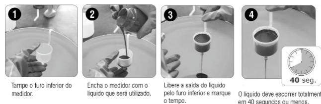
Fig. 2 – Medindo a viscosidade da tinta
