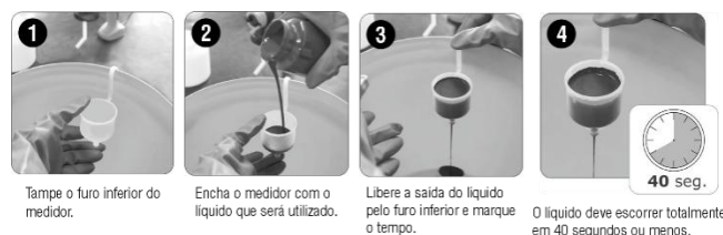
Fig. 2 – Medindo a viscosidade da tinta
